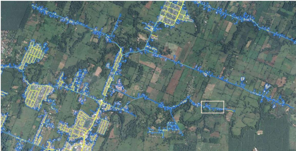
Figura 4: Detalle del área parcial de influencia ajustada mediante fotografía aérea a partir de las líneas de distribución.
